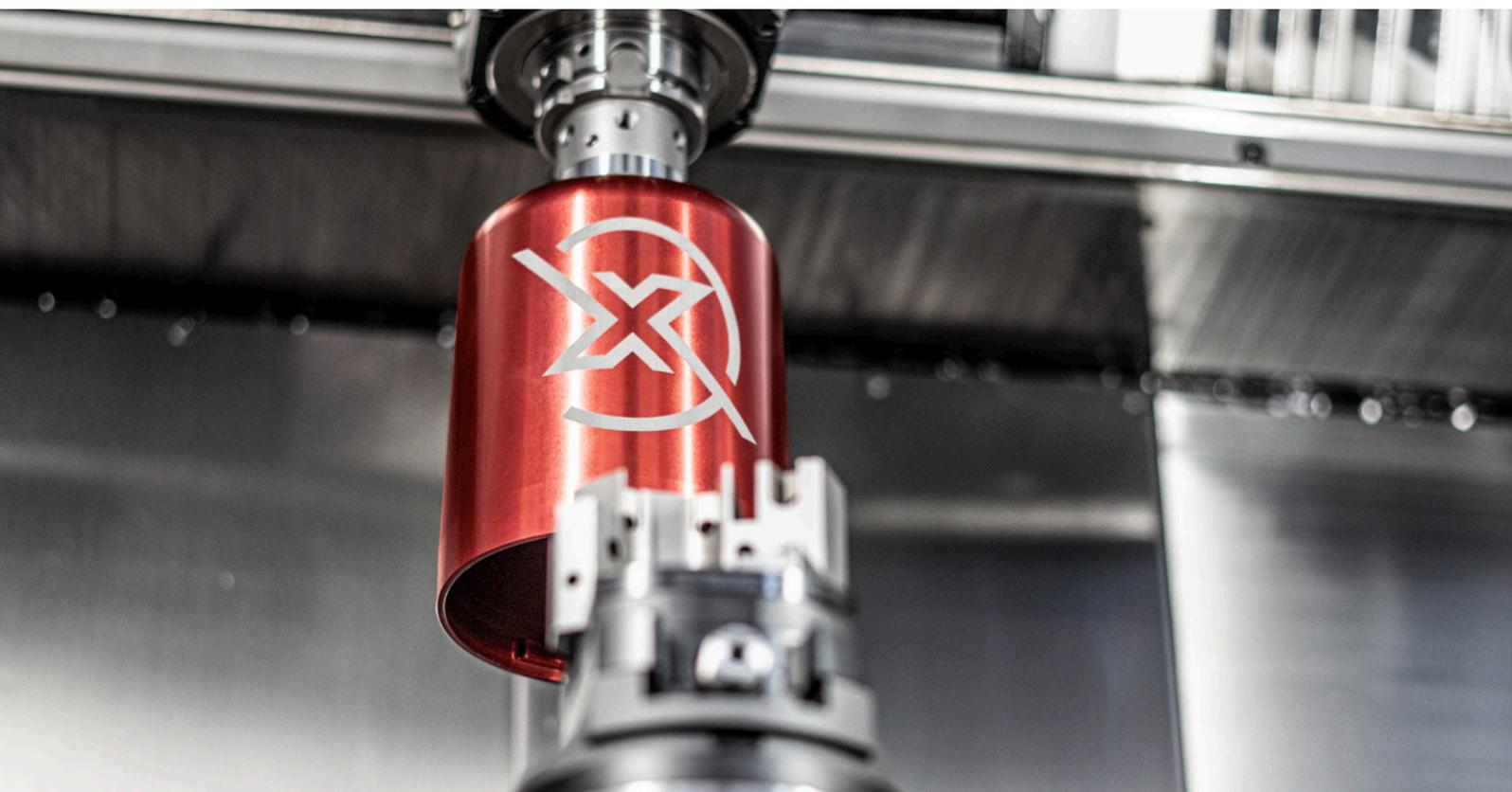
**HAUBEX** macht Ihr bestehendes Werkzeug-Wechselmagazin zu einem automatischen Werkstück-Wechsler.
